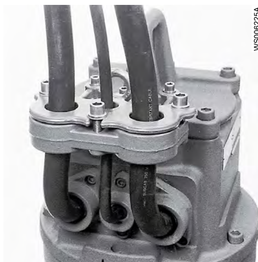
Рис. 16: Держатель кабеля. В насосах с MAS 801 нет вспомогательного кабеля.
